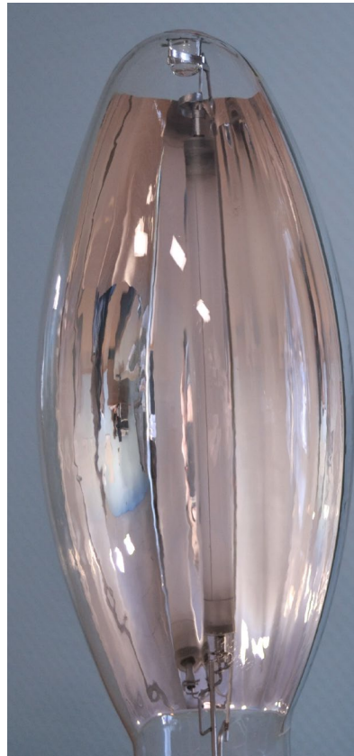
Лампа ДНа3/Reflux Ag после 6 000 часов наработки
